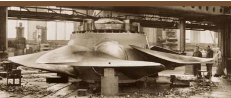
Rotor de uma turbina Kaplan em um grande torno de prato horizontal
