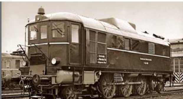
A primeira locomotiva diesel do mundo, com acionamento hidráulico Voith (1935)
